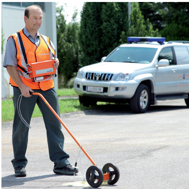
Im Zuge der routinemäßigen Wartung des Erdgasleitungsnetzes wird die Trasse mit dem Gasspürgerät abgegangen und dabei auf volle Funktionstüchtigkeit geprüft.
