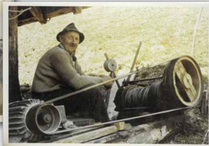
Mit dem Elektromotor wird eine Seilwinde angetrieben.
