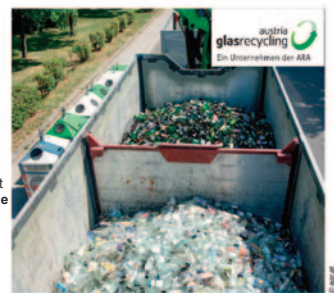
Gemeinsame Fahrt - trotzdem getrennt! Weiß- und Buntglas werden in zwei getrennte Kammern auf Sammelfahrzeug geleert.
