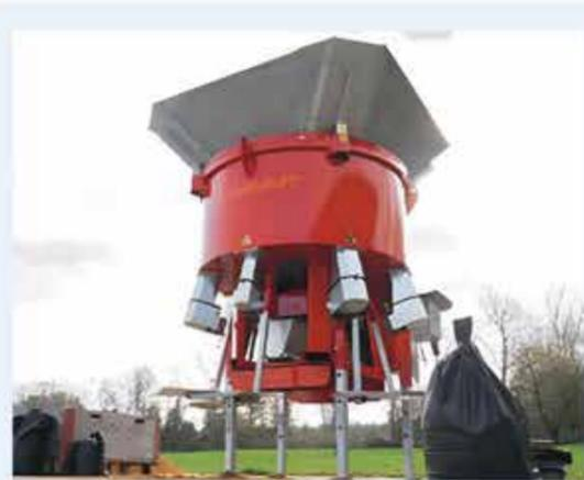
Insgesamt gibt es die TURBO PACKER Sandsackfüllmaschinen in verschiedenen Modellen von 240 Liter bis 2.000 Liter Nutzmenge. Die Type TP 150 5S hat eine Bauform mit runder Trommel und einem Mischkreuz. Diese verfügen bereits über fünf Auslassöffnungen und einem Zapfwellenantrieb – den Elektromotor gibt es hierbei dann als Option. Je nach Behältergröße ist bei diesen Typen eine Absackleistung von ca. 1.500 bis 3.800 Säcken pro Stunde möglich.
