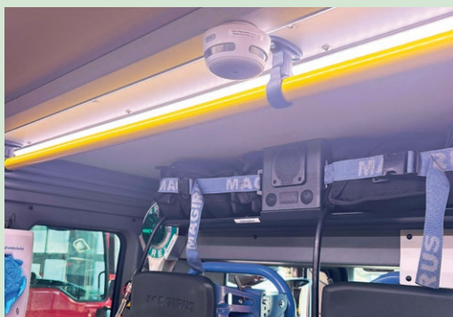
Mit dem Netzwerk verbundene Rauchmelder warnen schnell vor möglichen Bränden in den Fahrzeugen
