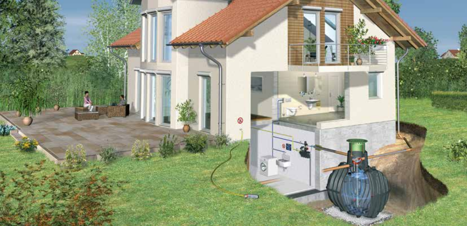
Abb. 5: Das gesammelte Regenwasser kann als Brauchwasser in Haus und Garten genutzt werden. © SCHÜTTER Behältercenter
