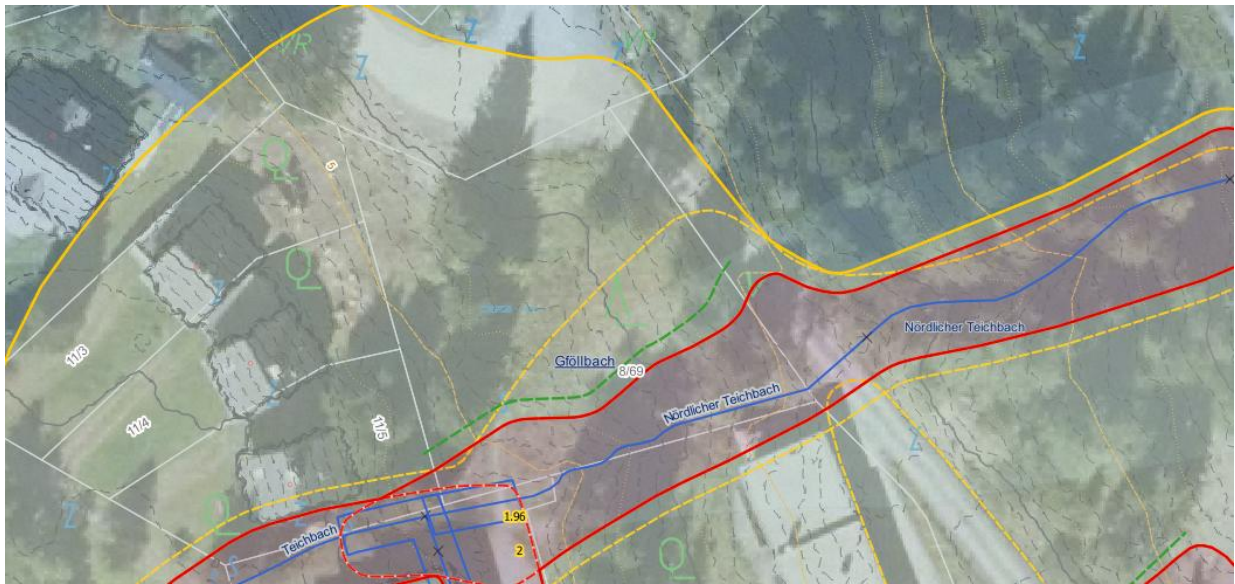
Abb. 1: Grüne Linie entlang der Roten Gefahrenzone beschreibt den Bereich der erheblichen Gefährdung
